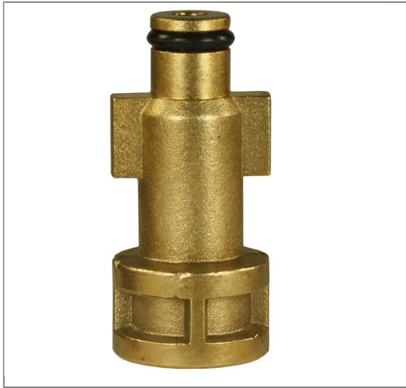
Stecknippel Bajonett AQUA/FAIP : 1/4" IG Material: Messing
