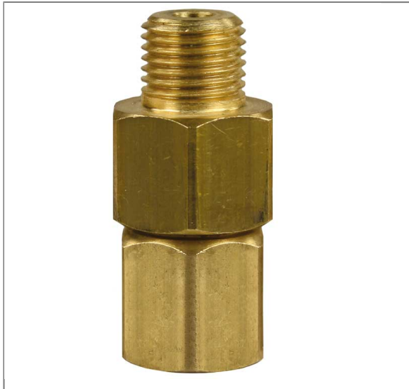
Drehgelenk ST-300 1/4" IG : 1/4" AG. Messing. Max. 275 bar / 90 °C
