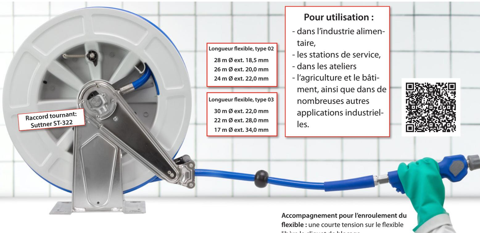
Accompagnement pour l'enroulement du flexible : une courte tension sur le flexible libère le cliquet de blocage.
