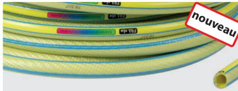
NTS jaune. Tuyau d'arrosage souple et pratique. CONSTRUCTION : 6 couches avec une couche intérieure jaune, une couche de protection anti-algues noire, une couche intermédiaire jaune, un renfort en tissu NTS, une gaine extérieure transparente et un revêtement SKY TECH avec une protection UV spéciale contre le vieillissement du tuyau qui donne à la surface du tuyau une finition mate.
