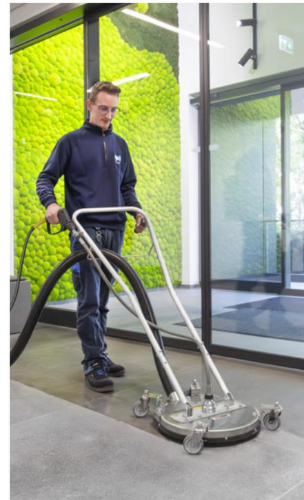
**Bien pensé :** l'étrier fixé sur le timon maintient le tuyau d'aspiration, assurant ainsi une utilisation aisée et sûre, sans risque de trébucher.
