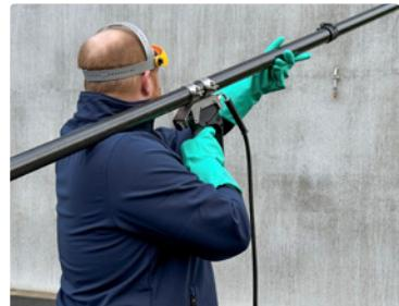
Düsenschutz ohne Mundstück mit Verlängerungsrohr 15° abgewinkelt. Für Düsenmundstücke ohne Gewinde, Düsenmutter "K".
