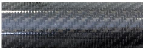
Hightech-Kohlenstofffasern: Carbon für stabile und leichte Teleskoprohre.
