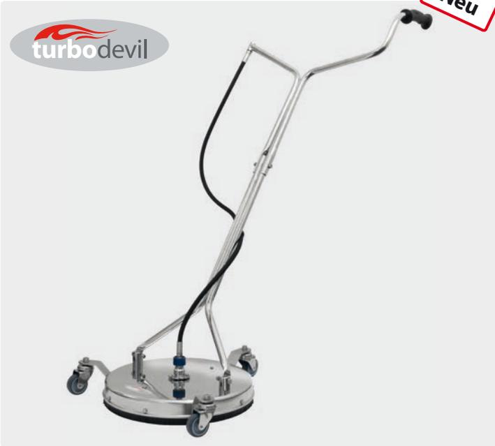
Flächenreiniger mit teilbarem Fahrbügel für platzsparenden und preisgünstigen Transport. Drehgelenk 3-fach kugelgelagert. 3 Lenkrollen (60 mm). Es werden 2 Düsen 1/4" AG benötigt. Max. 1.800 l/h / 60 °C. Max. 275 bar
