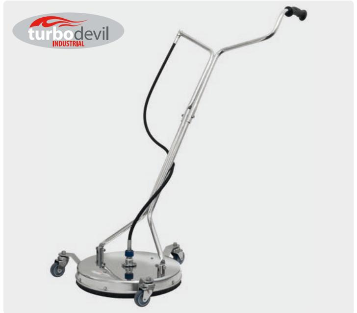
Flächenreiniger mit teilbarem Fahrbügel für platzsparenden und preisgünstigen Transport. Drehgelenk 3-fach kugelgelagert mit Keramik-Dichtelementen. 3 Edelstahl-Lenkrollen (60 mm). Es werden 2 Düsen 1/4" AG benötigt. Max. 1.800 l/h / 120 °C. Max. 275 bar
