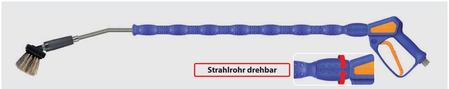
Strahlrohr mit umspritzter Isolierung Cool & Compact, **easywash365+** Pistole, **easywash365+** Strahlrohdrehgelenk, Luftinjektor **turbofoam365+** und Waschbürste (Borsten 60 mm). 20-150 bar. Max. 50 °C
