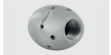
3/4"F. 6x 75° 3x 30° +1x 0°. 100-250 l/min. Pour \text{R} \text{D} 150-300 mm. \text{D} Extérieur 50 mm. \text{P} 1.367 g.
