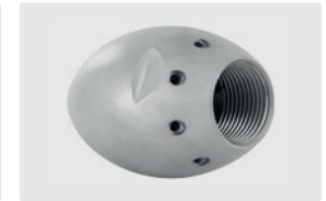
1"F. 8x 75° +1x 0°. 100-250 l/min. Pour \text{R} \text{D} 150-300 mm. \text{D} Extérieur 62 mm. \text{P} 1.265 g.
