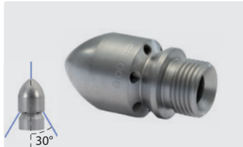
1/2" M BSP. Ø extérieur 30 mm. jets rétroactifs et avec jet frontal
