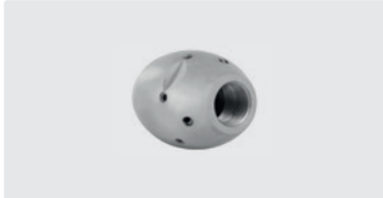
1/4"F. 6x 75° 3x 30° +1x 0°. 25-70 l/min. Pour \text{R} \text{D} 75-150 mm. \text{D} Extérieur 30 mm. \text{P} 223 g.
