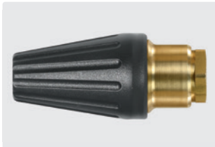
1/4" F. Spray angle 20°. 120 - 250 bar. Max. 100 °C
