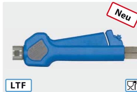
Professionelle Pistole mit Abschaltverzögerung und Öffnungsarretierung. Edelstahl. Anwendung z. B. Schaum- und Spülanwendungen in der Lebensmittelindustrie. Industriestandard. Max. 24,5 bar / 120 l/min / 100 °C
