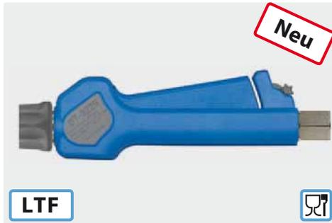
Professionelle Hochdruckpistole mit Abschaltverzögerung und Kupplung ST-3100. Edelstahl. Anwendung z. B. Schaum- und Spülanwendungen in der Lebensmittelindustrie. Industriestandard. Max. 60 bar / 120 l/min / 100 °C
