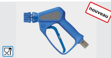
Pistolet professionnel avec coupleur ST-3100. Application destiné notamment à la mousse et au rinçage dans l'industrie alimentaire. Acier inoxydable/laiton. Clapet en acier inoxydable. Siège en PEEK. Joint en EPDM. Max. 150 bar / 80 l/min / 150 °C
