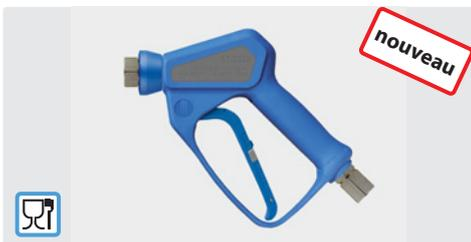
Pistolet professionnel. Application destiné notamment à la mousse et au rinçage dans l'industrie alimentaire. Acier inoxydable/laiton. Clapet en acier inoxydable. Siège en PEEK. Joint en EPDM. Max. 150 bar / 80 l/min / 150 °C
