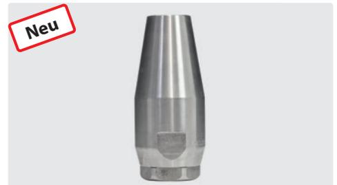
Edelstahl. 1/4" IG. Rotordüse mit 1 rotierenden Frontstrahl, 5 bis 8 Präzisionsbohrungen 0,4 mm für die Vorschubstrahlen hinten.
