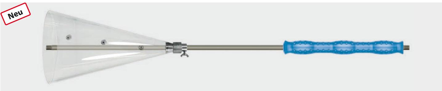
Strahlrohr mit Isolierung ST-29 Cool & Compact. Angenehm ergonomisch geformter Griff. Geschlossene Oberfläche. Mit Spritzschutztrichter, einstellbar mit Flügelschraube. Max. 400 bar / 80 °C
