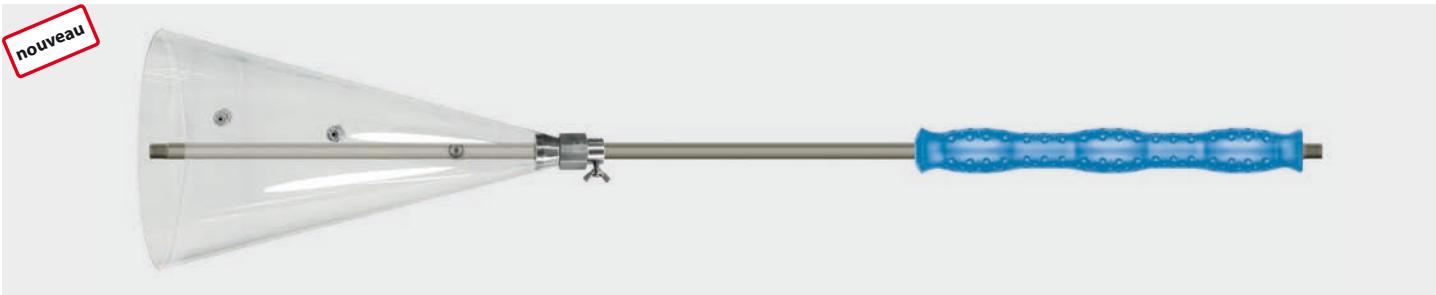
Lance avec manchon d'isolation ST-29 Cool & Compact. Prise en main ergonomique confortable. Surfaçage hermétique. Avec cône anti-éclaboussures, réglable par vis papillon. Max. 400 bar / 80 °C
