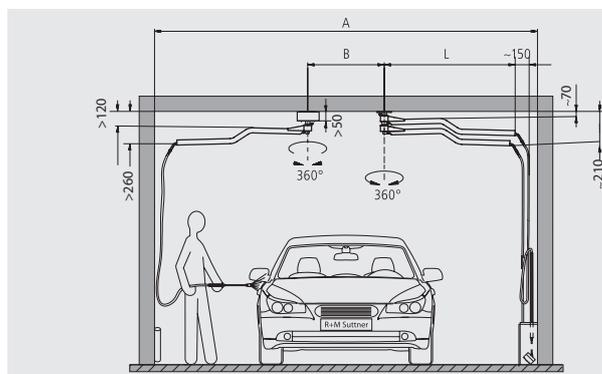
Exemple de montage avec bras de lavage double Z, bras de lavage simple Z et bras de lavage Z avec ressort
