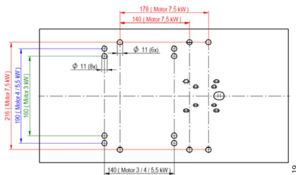
**Montage rapide et sécurisé :** Les pré perçages facilitent le montage des moteurs et des corps de filtre sur la plaque de montage.
