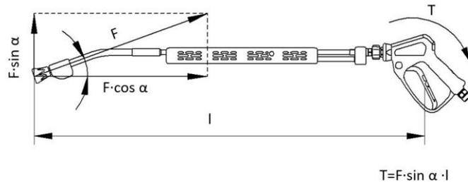
Beispiel: Drehmoment. Bei einer Rückstoßkraft von 100N, einer Länge von 1m und einem Winkel von 30°, beträgt das Drehmoment z.B. schon 50 Nm (100N x sin 30° x 1m).
