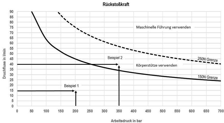
Beispiel 1: Bei einer Durchflussmenge von 15l/min und 200bar Arbeitsdruck ist die Rückstoßkraft kleiner als 150 N. Keine weitere Maßnahme ist nötig
